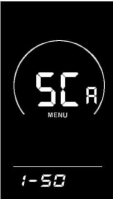
Fig. 8 Schermata di impostazione del valore del rapporto di servoassistenza
