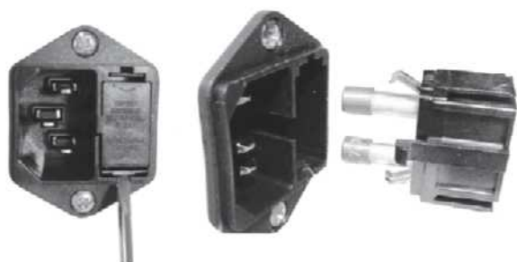
Fig. 3 Changement des fusibles
