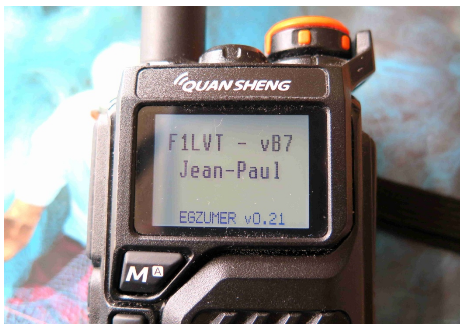
Photo 1 : Le TX QUANSHENG UV-K5 avec la version EGZUMER du firmware. On voit apparaître la mention « EGZUMER v0.21 » en bas de l'écran d'accueil.
