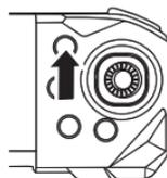
1. Definizione della direzione prima del decollo: la direzione in avanti del drone deve essere di fronte a voi (con una fotocamera rivolta in avanti). Allineare il telecomando con la coda del volo e premere un pulsante per decollare, per completare la definizione della direzione della modalità senza testa per questo volo.
