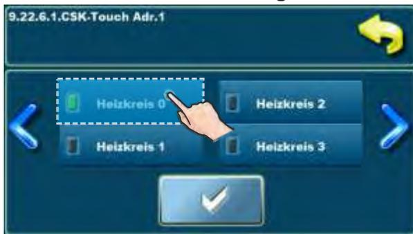
Bei direktem Anschluss an den Heizkessel muss bei der Konfiguration des Heizkreises am CSK-Touch der „Heizkreis 0“ gewählt werden
