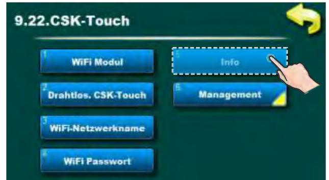
Nach der Konfiguration der Heizkreise am CM2K-Modul, ist im CSK-Touch Menü das Menü „INFO“ zu öffnen und die CSK-Touch WiFi ID (1) und Adresscodes (2) (je nach Anzahl der eingebauten Korrektoren), die dann bei der Konfiguration in jedem CSK-Touch eingetragen werden muss.
