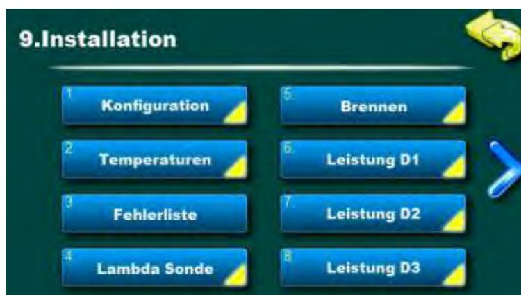
Im Installationsmenü drücken Sie "Konfiguration" und bestätigen Sie das mit der Taste "ENTER"
