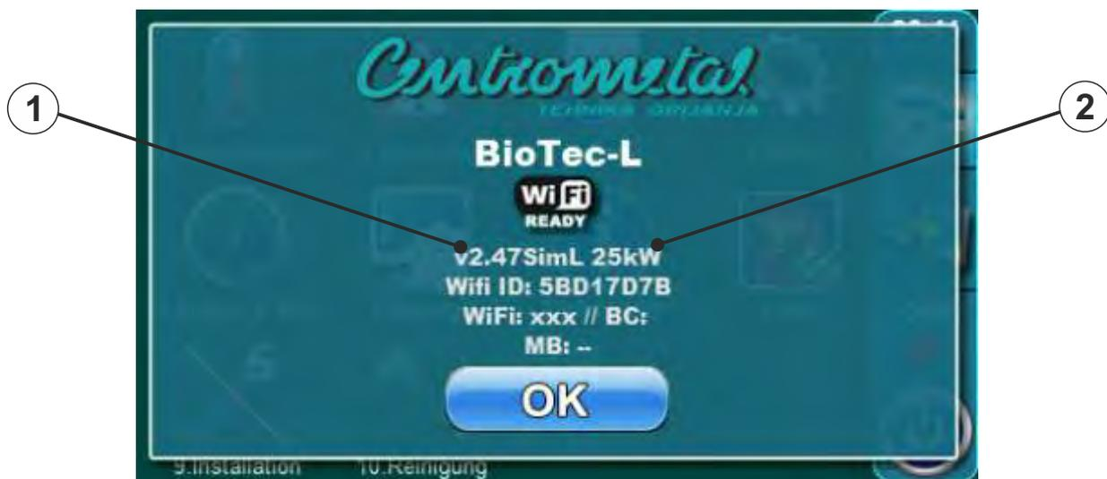
Bei dieser Funktion wird die Softwareversion (1) und die Kesselnennleistung (2) angezeigt.
