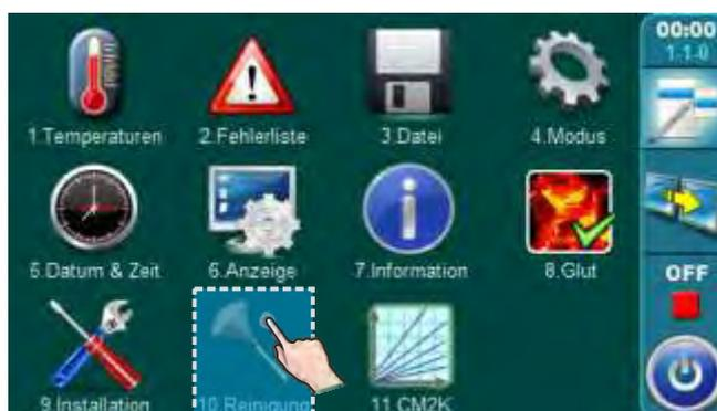
Beim Reinigen des Kessels wird durch Anwahl der Funktion „10.Reinigung“ das Saugzuggebläse für eine Dauer von bis zu 30 Minuten eingeschaltet. Dies verhindert einen übermäßigen Staubaustritt während der Reinigung.
