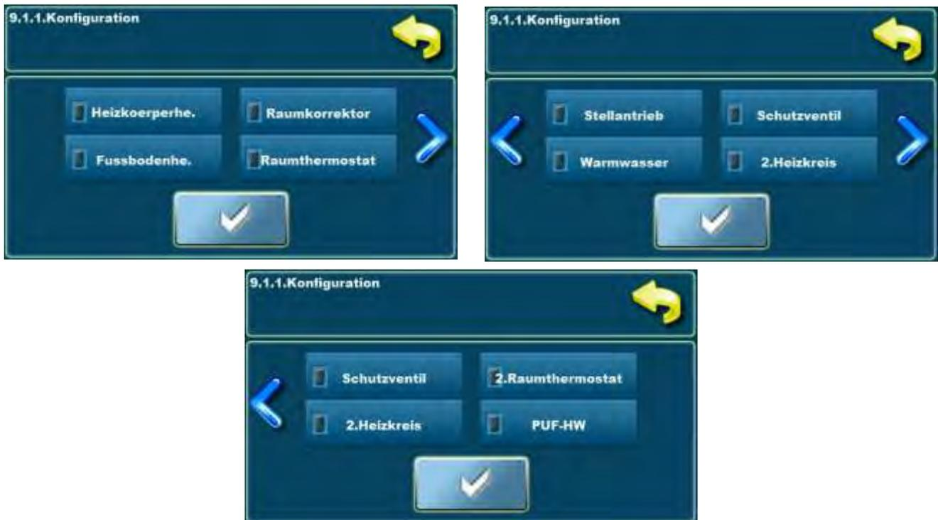
Konfigurieren Sie Ihr System durch die Anwahl der entsprechenden Komponenten. Durch die Auswahl einiger Komponenten werden andere Möglichkeiten teilweise ausgeschlossen (z.B. Sie können entweder Beheizung mit Heizkörpern oder Fußbodenheizung auswählen, nicht jedoch beides). Andere Komponenten können wiederum nur angewählt werden in Zusammenhang mit einer anderen Komponenten (z.B. Raumthermostat kann nur gewählt werden, wenn auch ein Heizkreis ausgewählt wird.)
