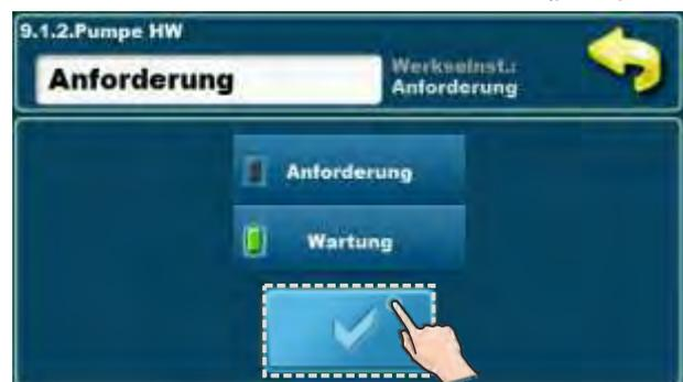
**Anforderung** – Pumpe PUF-HW (6) (P2 oder P3, je nach Konfiguration) funktioniert, wenn eine Anforderung von der vom Kessel oder CM2K-Modul gesteuerten Pumpe oder von der WW Pumpe vorliegt und wenn die Bedingung  $T_{puf} > T_{puf\_min}$  erfüllt ist. Bei Bedarf kann die PUF-HW Pumpe im Menü 4 für den Dauerbetrieb aktiviert werden -> 4. Modus -> 4.6 Pumpe HW Const. (zB. Frostschutz-Modus).
