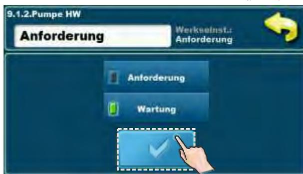
**Anforderung** – Pumpe PUF-HW (6) (P2 oder P3, je nach Konfiguration) funktioniert, wenn eine Anforderung von der vom Kessel oder CM2K-Modul gesteuerten Pumpe oder von der WW Pumpe vorliegt und wenn die Bedingung  $T_{puf} > T_{puf\_min}$  erfüllt ist. Bei Bedarf kann die PUF-HW Pumpe im Menü 4 für den Dauerbetrieb aktiviert werden -> 4. Modus -> 4.6 Pumpe HW Const. (zB. Frostschutz-Modus).
