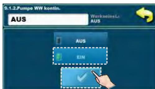
Wenn es zu einer Störung des WW Fühlers kommt (Störung E1), kann die Steuerung die WW Pumpe nicht automatisch ansteuern. Der Service-Mitarbeiter kann zur Durchführung von Reparaturarbeiten die WW Pumpe manuell einschalten. In diesem Fall läuft die WW Pumpe durch und solange bis sie vom Service -Mitarbeiter manuell abgeschaltet wird.
