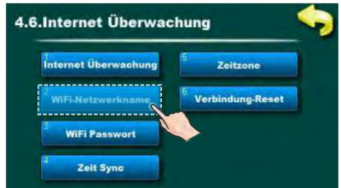
Mit dieser Option können Sie den Namen des lokalen WiFi-Netzwerks eingeben, mit dem die Cm WiFi-Box und der Kessel verbunden sind. Sie müssen den korrekten WiFi-Netzwerkname eingeben, sonst kann der Kessel keine Verbindung zum WiFi-Netzwerk herstellen.
