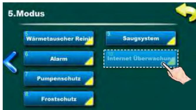
Wenn die Internetüberwachung verbunden und aktiviert ist, wird auf dem Hauptbildschirm ein neues Symbol angezeigt, das den Status der Internetüberwachung (Internet Kessel-Verbindung und Webportal) anzeigt.
