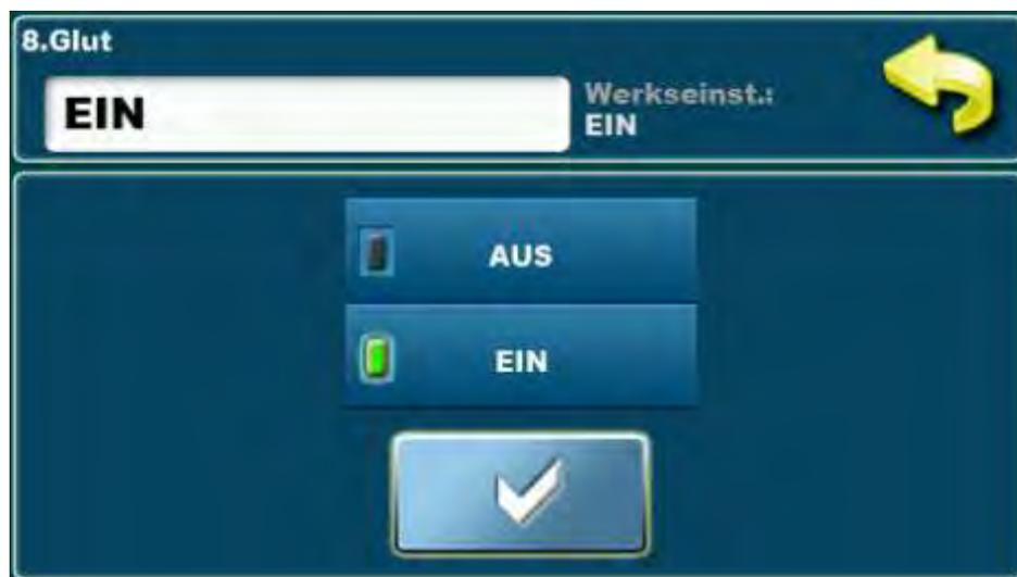
Im Menü „**Glut**“ kann die Option Glut-Haltung ein- oder ausgeschaltet werden.
