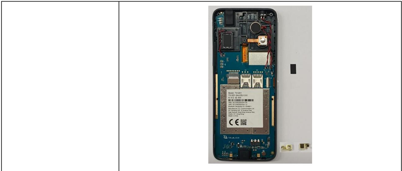
Desaperte o PCBA principal; coloque-o na caixa frontal.
