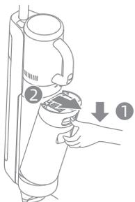
2. Estrai il filtro dal coperchio del Serbatoio dell'Acqua Usata. Rimuovi il coperchio del serbatoio e versa l'acqua di scarico.
