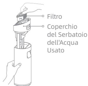
3. Sciacqua il serbatoio dell'acqua usata e il coperchio del serbatoio con acqua pulita. Pulisci la parete interna del serbatoio con la spazzola in dotazione.
