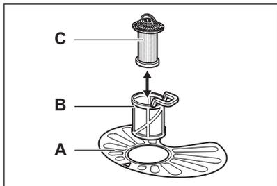
1. Ruotare il filtro (B) in senso antiorario e rimuoverlo.
