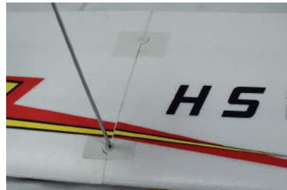
2. Nehmen Sie den Rumpf und das Höhenleitwerk sowie die kurze Flügelverbindungsstange heraus. Stecken Sie die kurze Flügelverbindungsstange in die Montagelöcher vom Seitenrudder, dann führen Sie die Verbindungsstange in den linken und rechten Höhenleitwerk ein. Befestigen Sie das Höhenleitwerk mit Schrauben.
