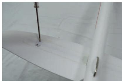
3. Legen Sie die montierten Haupttragflächen in die richtige Position auf die Oberseite des Rumpfes, befestigen Sie die Tragflächen gut mit Schrauben am Rumpf.
