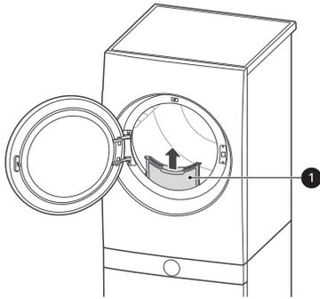
Asegúrese siempre de que el filtro de pelusa esté instalado correctamente antes de poner en funcionamiento la secadora. Hacer funcionar la secadora sin el filtro o con el filtro de pelusa suelto podría dañar la secadora y las prendas que se encuentran en su interior.
