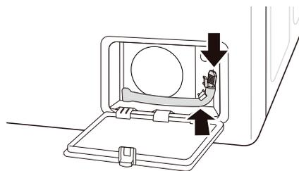
**7** Inserte el filtro de la bomba de desagüe y gírelo hacia la derecha.
