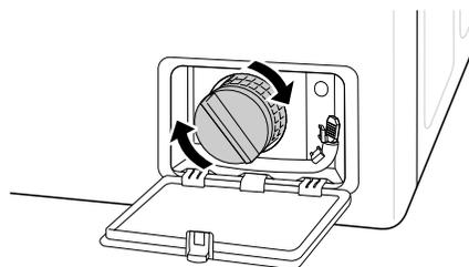
**8** Cierre la cubierta del filtro de la bomba de desagüe.
