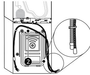
**Conexión de la manguera de desagüe a la secadora**
