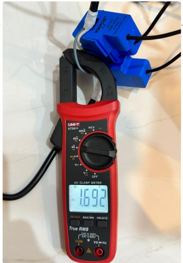
Bild 8. Einsatz des Zangen-Strommessers bei der Kalibrierung.
