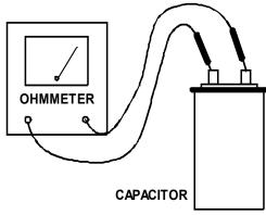
**TESTING CAPACITOR RESISTANCE**
