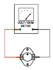
**TESTING AUXILIARY LIMIT CONTROL**
