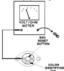
**CHECKING FLAME ROLLOUT SWITCH**
