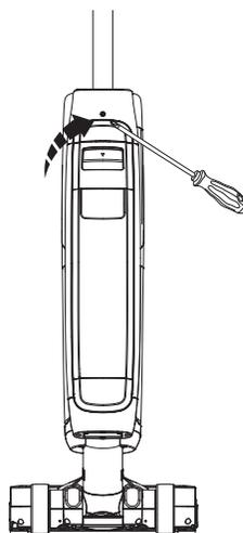
Dans le cas où la poignée doit être démontée, appuyez sur le ressort pour libérer la poignée à l'aide d'un outil (par exemple un tournevis) et soulevez la poignée de l'appareil.
