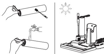
Utilisez l'outil de nettoyage pour retirer les cheveux et les débris enroulés autour du rouleau et rincez celui-ci à l'eau. Remplacez le rouleau brosse dans le porte-accessoires et laissez-le sécher complètement avant de le réinstaller.
