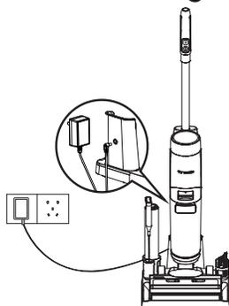
Pour charger l'appareil, placez-le sur la station de recharge et branchez l'adaptateur sur une prise secteur.
