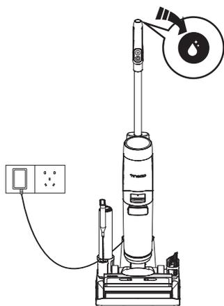
1. Placez l'appareil sur la station de recharge après l'utilisation, le capteur détecte automatiquement le niveau de saleté.
