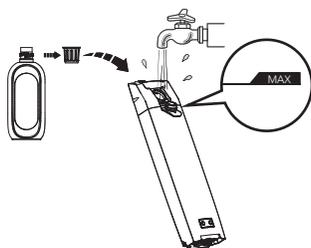
Ouvrez le bouchon du réservoir et remplissez-le d'eau du robinet jusqu'à la ligne Max. Si un nettoyage en profondeur est nécessaire, ajoutez un bouchon de flacon de solution dans le REP et fermez fermement le bouchon.
