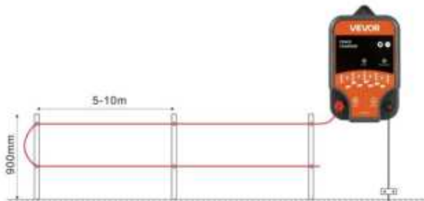
Schéma de câblage à deux fils
