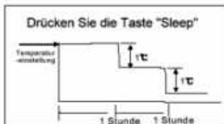
Temperaturabsenkung im Heizbetrieb
