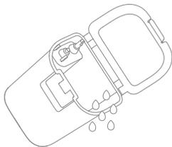
2. Rincez le réservoir d'eau sale avec de l'eau propre et utilisez la brosse de nettoyage fournie pour nettoyer la paroi intérieure du réservoir.
