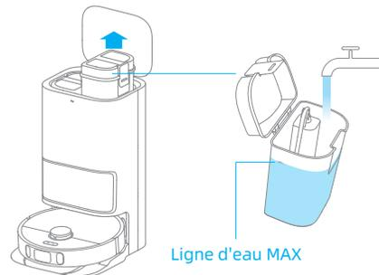
**Remarque :** ne remplissez pas d'eau chaude, sinon le réservoir risque de se déformer.
