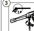
Raccordement du tuyau à haute pression à la poignée de la gâchette.
