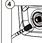
Raccordez le tuyau à haute pression au raccord de la sortie d'eau.
