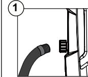
Una la pistola de la hidrolimpiadora a presión a la lanza de pulverización.
