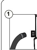
Raccordez le tuyau d'arrosage à la prise d'eau de la laveuse à pression.
