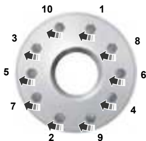
10-lug nut torque sequence
