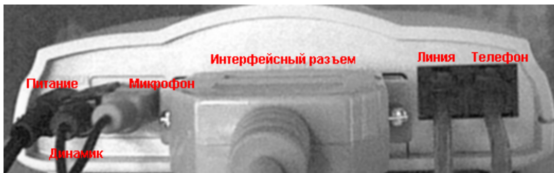
Рис. 1 Подключение соединительных шнуров к модему
