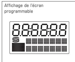
L'écran LCD peut être programmé via l'interface EtherCAT. Si seule une grandeur de sortie est sélectionnée, l'affichage est statique. Il est cyclique si plusieurs grandeurs sont sélectionnées.
