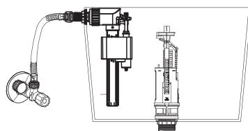
Molimo zatvorite kutni ventil prilikom podešavanja razine na uljevnom ventilu
