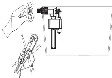
Kako je prikazano na slici postavite uljevni ventil na vodokotlić i ne koristite ključ
