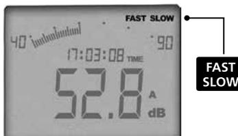
Das Gerät verfügt über zwei unterschiedliche Messintervalle. Bei Signalen, die sich schnell verändern, sollte die Zeitbewertung "FAST" eingestellt werden. Bei kontinuierlichen Signalen, die sich langsam verändern, sollte die Zeitbewertung "SLOW" eingestellt werden. Der Messintervall bei "FAST" beträgt 125 Millisekunden, bei "SLOW" 1 Sekunde. Durch Drücken der Taste "FAST/SLOW" kann die Zeitbewertung während der Messung jederzeit umgeschaltet werden.
