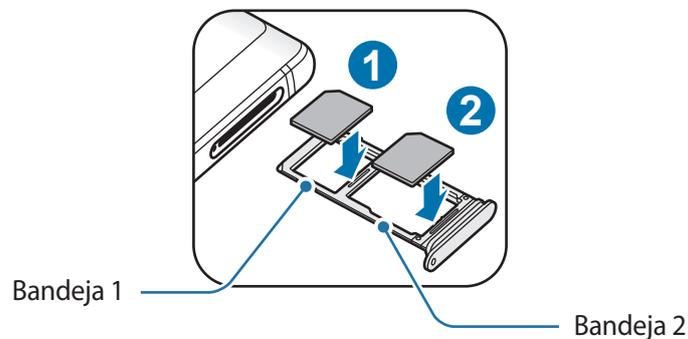
4 Presione suavemente la tarjeta SIM o USIM hacia la bandeja para fijarla.
