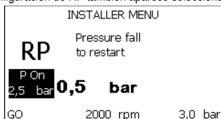
Figura 18.1: Configuración de la presión de reencendido (2)
