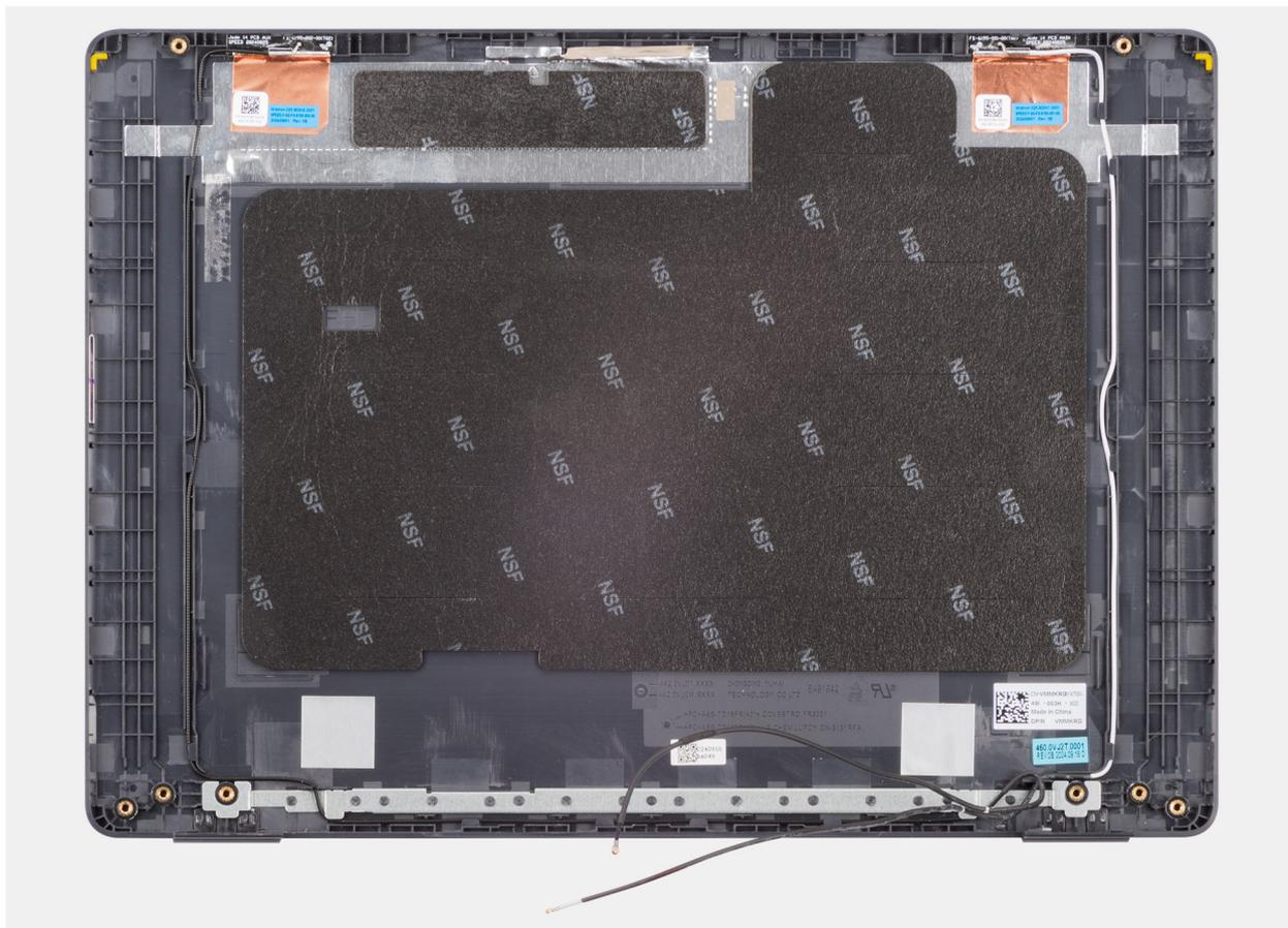
**Figure 87. Installation de l'assemblage du capot arrière de l'écran**
