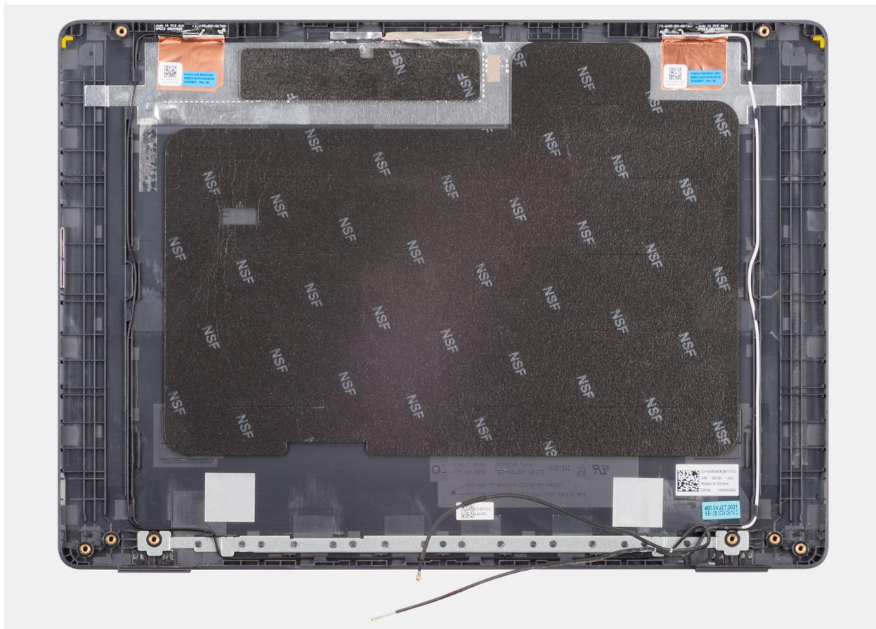
Figure 86. Retrait de l'assemblage du capot arrière de l'écran
