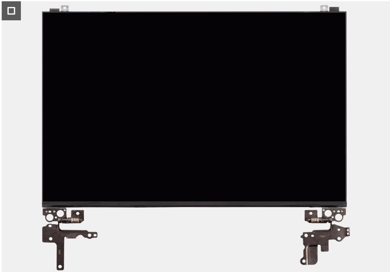
Figure 77. Retrait de l'assemblage du panneau d'écran
