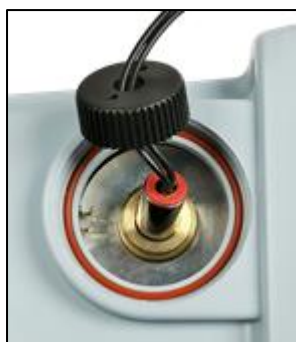
Install the new tungsten filament lamp module.
