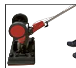
Deichsel auf Kopf stellen für maximales Arbeitsgewicht
