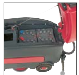
Maschine offen mit Batterien
