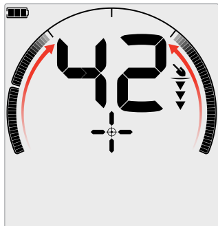
Isyarat sasaran yang lemah/luar pusat: Sedikit segmen beza layan Dihidupkan. Sasaran terletak lebih dekat dengan bahagian luar gegelung.
