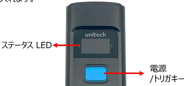
2. RP902 MFiの電源を初めて入れると、通信LEDは最初に緑の点滅を示し、次にRP902 MFiがBluetooth接続を待っていることを示す"青の点滅"を示します。
