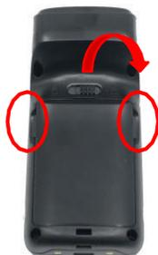
3. バッテリーを上側から挿入し、押し込んで、バッテリーのストラップの半分が外に出るようにします。
