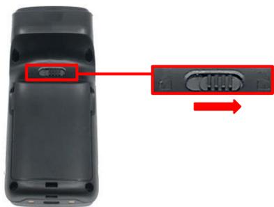
2. バッテリーカバーの両側に付いている二つの突起をつかみ、上方に持ち上げて外します。
