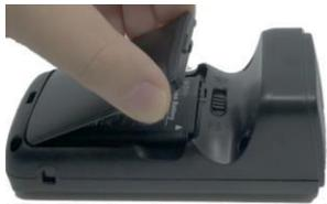
6. バッテリーカバーを押し下げ、バッテリーロックを左側に押してバッテリーを固定します。
