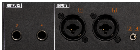
Die Ausgänge und Eingänge auf der Vorderseite
