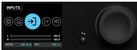
Display, Haupt-Drehregler und Back-Taster
