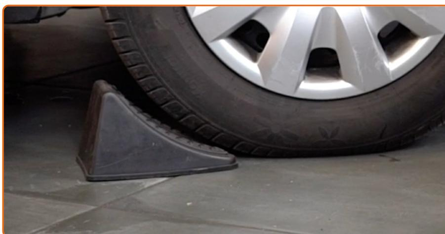
Sichern Sie die Räder mit Hilfe von Unterlegkeilen.
