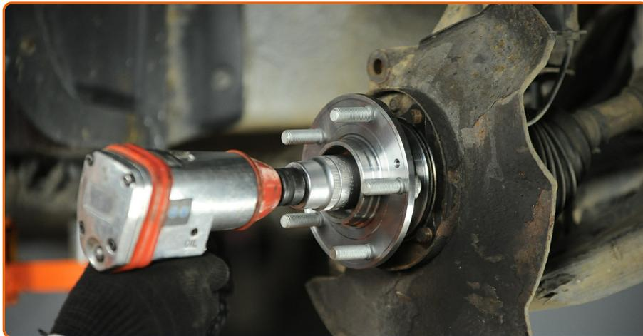
Ziehen Sie die Radnabenmutter fest. Verwenden Sie Stecknuss Nr. 32. Verwenden Sie einen Drehmomentschlüssel. Ziehen Sie ihn mit 195 Nm Drehmoment fest.
