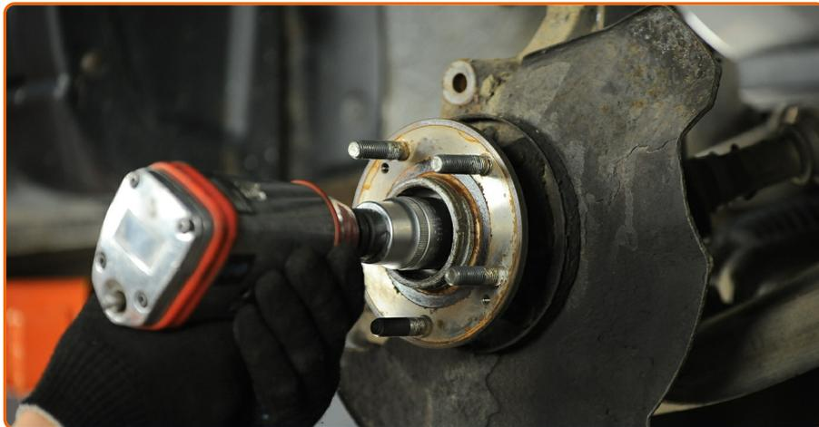
Schrauben Sie die Nabenmutter ab. Verwenden Sie Stecknuss Nr. 32. Verwenden Sie einen Ratschenschlüssel.
