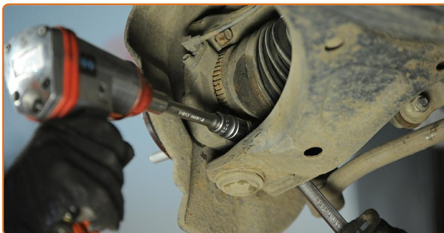
Ziehen Sie das Befestigungselement fest, das das Traggelenk mit dem Achsschenkel verbindet. Verwenden Sie Ring-Gabelschlüssel Nr. 19. Verwenden Sie Stecknuss Nr. 18. Verwenden Sie einen Drehmomentschlüssel. Ziehen Sie ihn mit 73 Nm Drehmoment fest.
