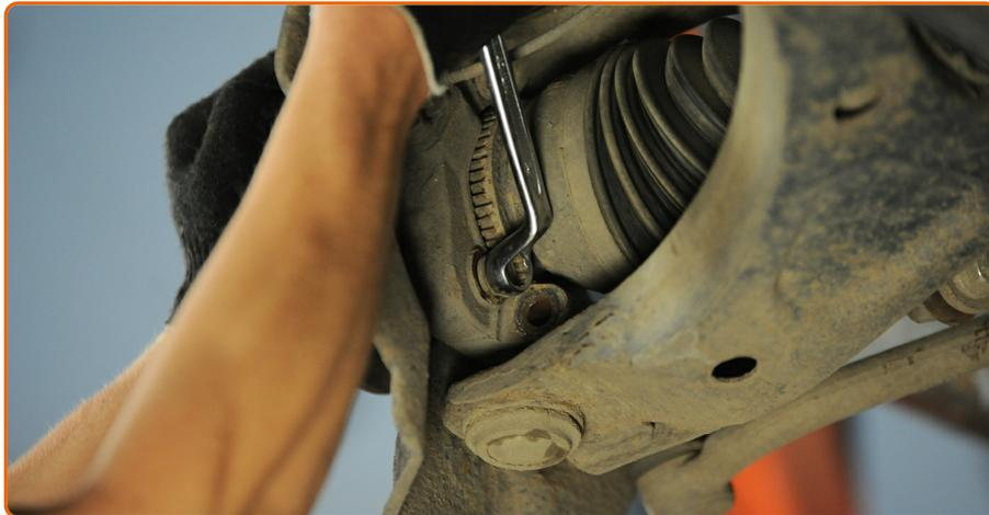
Schrauben Sie die Befestigung ab, die das Radnabenlager mit dem Achsschenkel verbindet.
