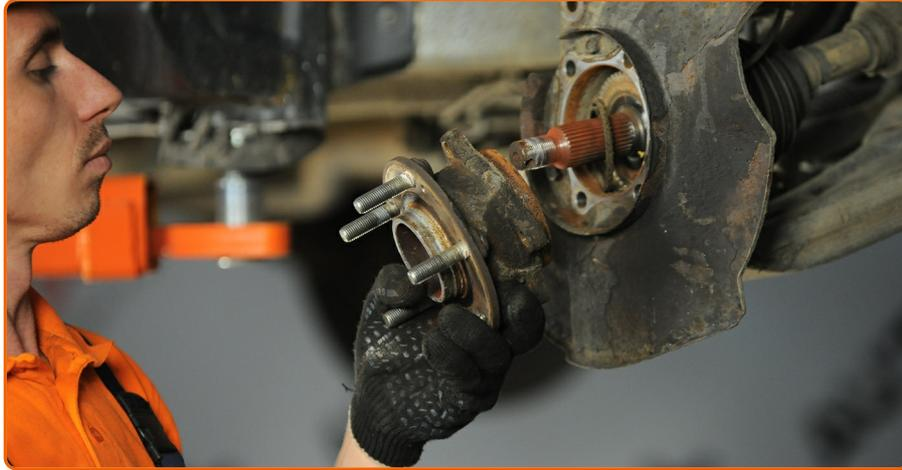
Entfernen Sie die Nabe und das Lager zusammen, da sie eine versiegelte Einheit sind.
