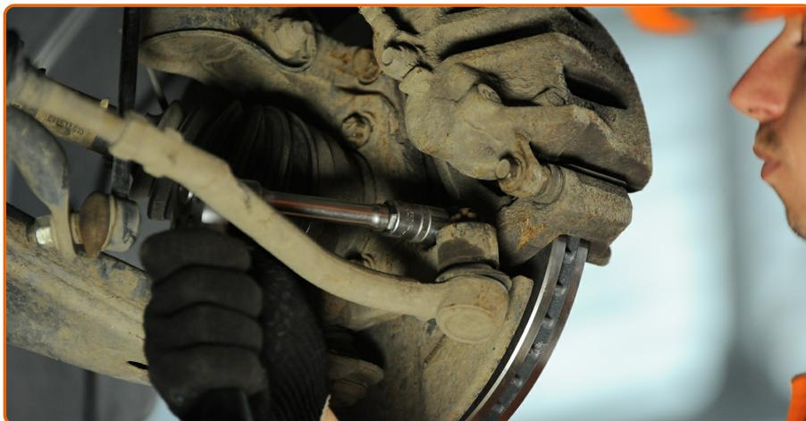
Befestigen Sie die Bremssattelhalterung. Verwenden Sie Ring-Gabelschlüssel Nr. 17. Verwenden Sie Stecknuss Nr. 17. Verwenden Sie einen Drehmomentschlüssel. Ziehen Sie ihn mit 80 Nm Drehmoment fest.
