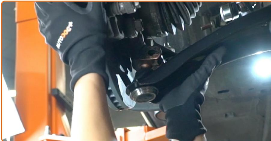
Verbinden Sie das Kugelgelenk mit dem Achsschenkel.
