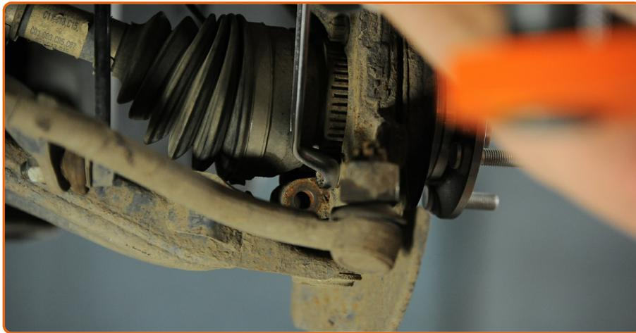
Ziehen Sie das Befestigungselement des Radnabenlagers an.
