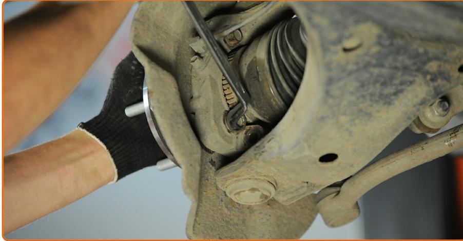
Verwenden Sie Ring-Gabelschlüssel Nr. 14. Verwenden Sie Stecknuss Nr. 14. Verwenden Sie einen Drehmomentschlüssel. Ziehen Sie ihn mit 78 Nm Drehmoment fest.
