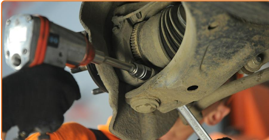
Schrauben Sie die Kugelgelenkbefestigung vom Achsschenkel ab. Verwenden Sie Ring-Gabelschlüssel Nr. 19. Verwenden Sie Stecknuss Nr. 18. Verwenden Sie einen Ratschenschlüssel.
