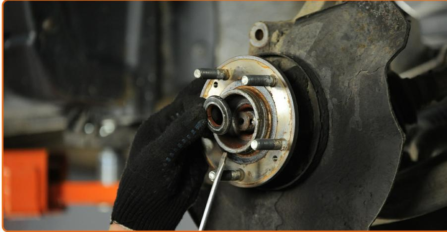
Entfernen Sie die Befestigungsmutter.
