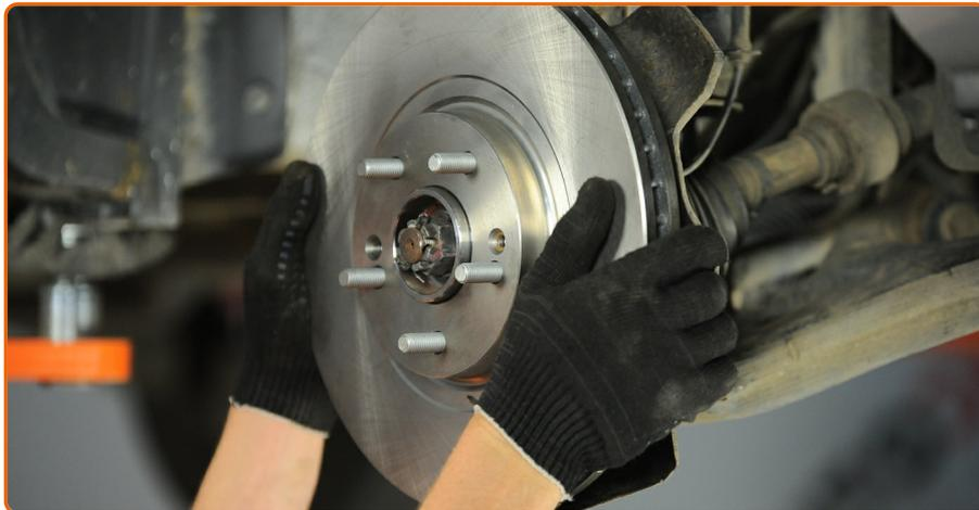
Montieren Sie die neue Bremsscheibe auf der Nabe und schrauben Sie die Befestigungen ein. Verwenden Sie einen Kreuzschlitzschraubendreher.
