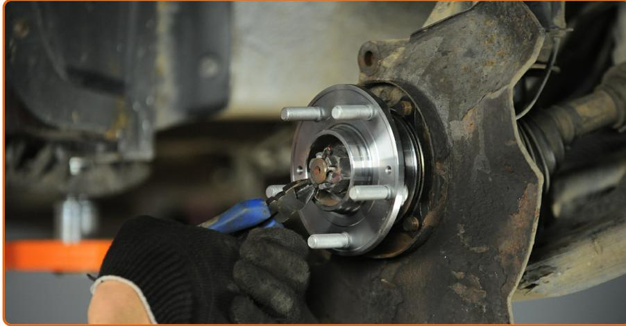
Sichern Sie die Nabenmutter mit einem neuen Splint. Verwenden Sie eine Kneifzange. Benutzen Sie einen Hammer.
