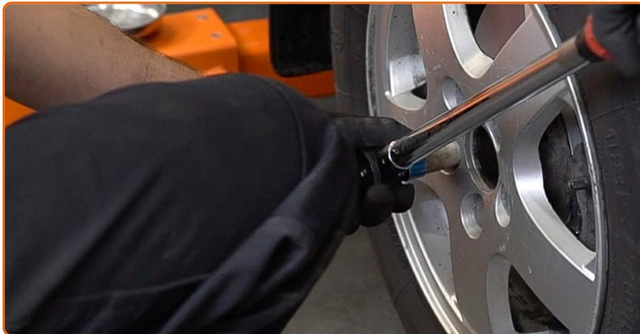
Senken Sie das Auto und ziehen Sie die Radschrauben über Kreuz an. Verwenden Sie eine Schlagnuss für Felgen # 21. Verwenden Sie einen Drehmomentschlüssel. Ziehen Sie ihn mit 120 Nm Drehmoment fest.
