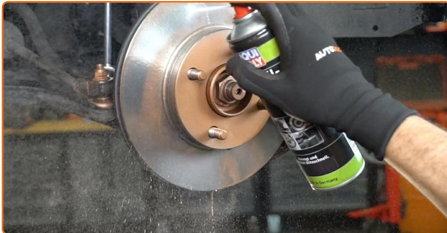
Die Bremsscheibenoberfläche reinigen. Benutzen Sie einen Bremsenreiniger.
