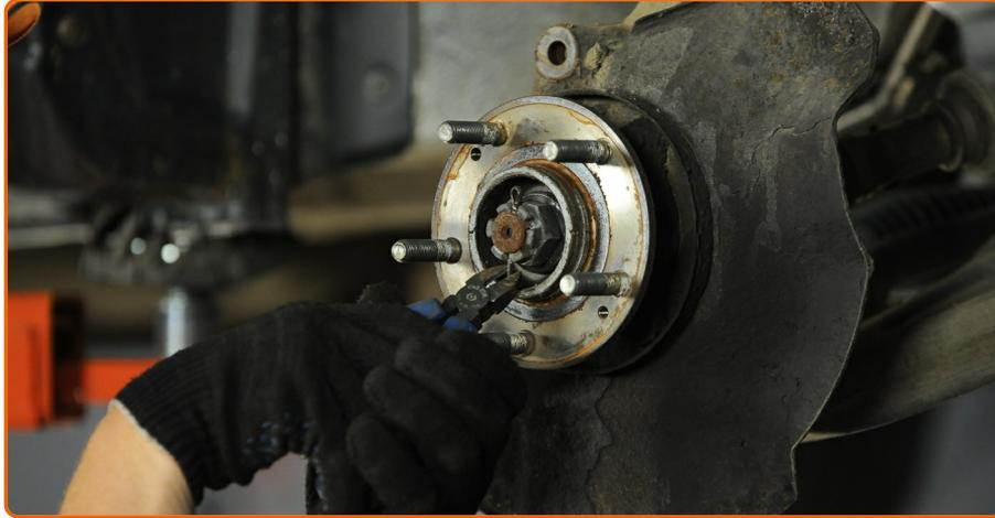
Entfernen Sie den Splint, der die Nabenmutter sichert. Verwenden Sie eine Kneifzange.
