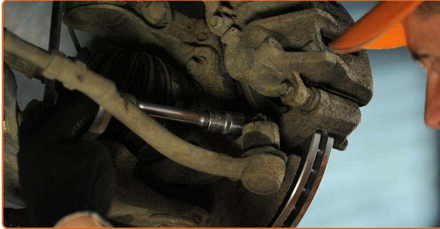
Lösen Sie die Befestigung der Sattelhalterung. Verwenden Sie Ring-Gabelschlüssel Nr. 17. Verwenden Sie Stecknuss Nr. 17. Verwenden Sie einen Ratschenschlüssel.
