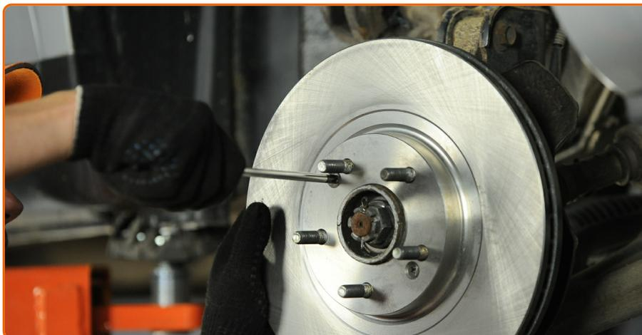
Schrauben Sie die Befestigungen der Bremsscheibe ab und entfernen Sie letztere. Verwenden Sie einen Kreuzschlitzschraubendreher.
