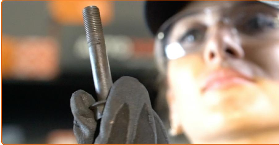
Entfernen Sie die Befestigungsschraube. Benutzen Sie einen Hammer. Verwenden Sie einen Splintentreiber.
