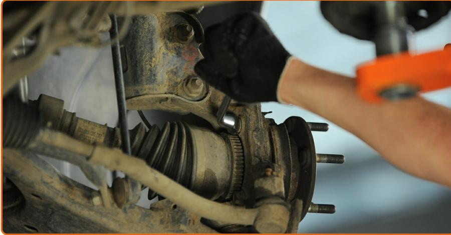
Verwenden Sie Stecknuss Nr. 14. Verwenden Sie einen Ratschenschlüssel.
