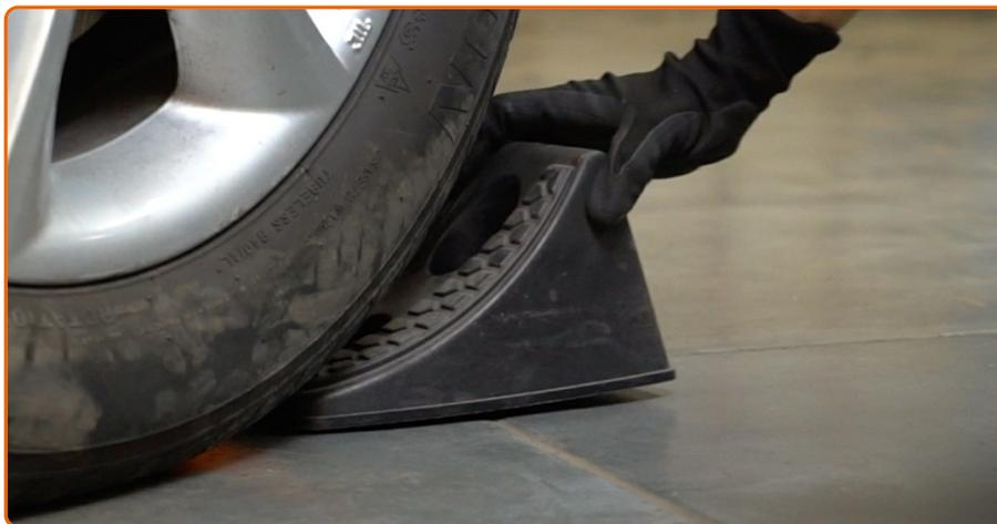
Entfernen Sie den Wagenheber sowie die Unterlegkeile.
