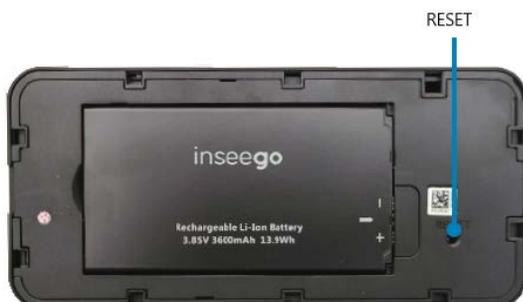
2. Coloque un extremo de un clip desplegado en el orificio **RESET** (Reiniciar) y presione hasta que la pantalla muestre **M2000 Resetting** (Reiniciando M2000) (entre cinco y seis segundos). Su M2000 se reinicia con la configuración predeterminada.
