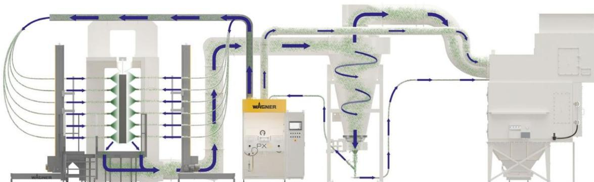
Sistema completo per polveri con contenitore per l'efficienza energetica: Il flusso d'aria ottimizzato del sistema riduce il consumo energetico del motore del filtro finale fino al 40% rispetto ai sistemi convenzionali presenti sul mercato.
