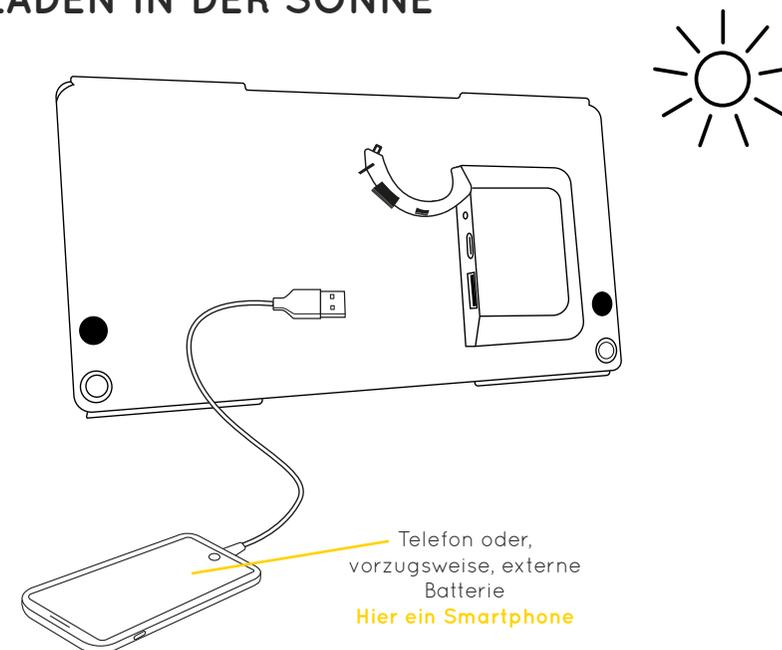
Der Fusion Core lädt mit der Energie der Sonne. Klappen Sie das Solarladegerät aus und legen Sie es in die Sonne. Schließen Sie Ihr Gerät an der Rückseite des Fusion Core mit einem USB-Kabel an. Das Gerät beginnt sofort zu laden.
