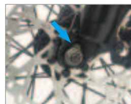
4. Serrer les écrous gauche et droit comme indiqué
