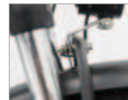
5. Installare le luci e i parafranghi e collegare i fili delle luci (notare che le frecce alle due estremità del cablaggio corrispondono).
