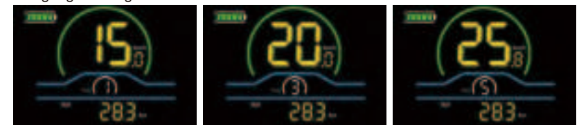
Schnittstelle zur Anzeige des PAS-Levels
