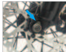
4. Ziehen Sie die linke und rechte Mutter wie dargestellt
