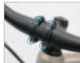
1. Installare il riser del manubrio
