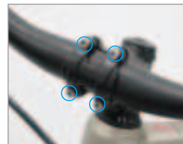
1. Instalar el elevador del manillar
