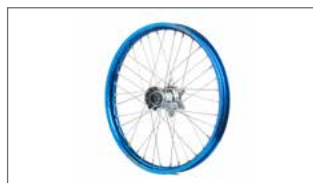
Przednie koło MXGP Replica (1,60" x 21") 1SL-F2053-7R-P1
