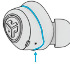
Le Cush Fin doit être aligné en positionnant le contour autour du trou du microphone.
