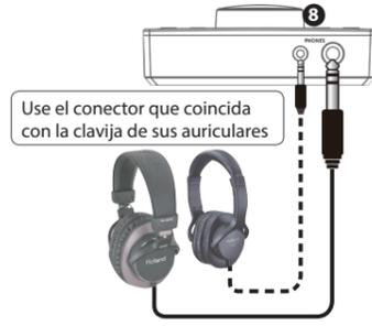
Use el conector que coincida con la clavija de sus auriculares
