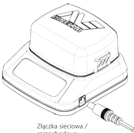
Ilustracja 36 – Ładowarka BC 10 z gniazdem na wtyczkę oraz złączem USB.
