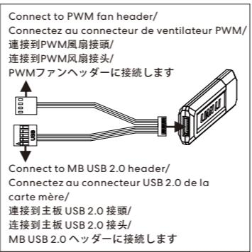
Connect to PWM fan header/ Connectez au connecteur de ventilateur PWM/ 連接到PWM風扇接頭/ 连接到PWM风扇接头/ PWMファンヘッダーに接続します
