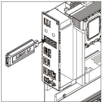
Each L-Wireless Controller supports 10 channel of device/ Chaque L-Wireless contrôleur prend en charge 10 canaux d'appareil/ 每個L-無線控制器支持10個设备通道/ 每个L-无线控制器支持10个设备通道/ 各L-Wirelessコントローラーは10のデバイス チャネルをサポートします
