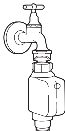
Tuyau d'arrivée d'eau de sécurité
