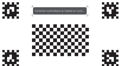
Remarque : Une fois la correction automatique du trapèze terminée, vous pouvez également appuyer sur le bouton de confirmation de la télécommande pour saisir la correction manuelle du trapèze et utiliser la télécommande pour ajuster les coins de l'image pour la correction.
