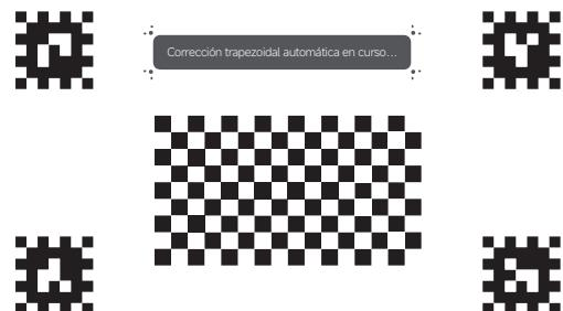
**Nota:** Una vez que se complete la corrección trapezoidal, también puede presionar el botón de confirmación en el control remoto para entrar al modo de corrección trapezoidal manual y usar el control remoto para ajustar con precisión las esquinas de la imagen para fines de corrección.
