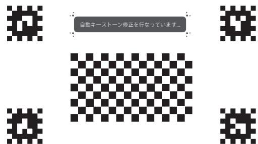
注意：自動キーストーン修正が完了した後、リモコンの確認ボタンを押して手動キーストーン修正に入ります。また、リモコンを使用して画像の四隅を微調整して修正することもできます。
