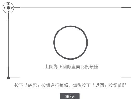
**提示：**自動梯形修正完成後，也可以短按遙控器確認鍵進入手動梯形修正，透過遙控器控制畫面頂點進行微調。
