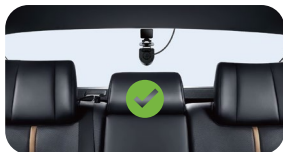
Méthode d'installation de la caméra arrière RC09 (en option)
