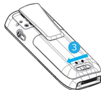
电池模块安装到位后, 将锁滑到锁定位置。
