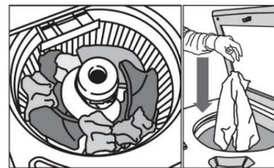
Pour un meilleur rendement, il est recommandé de charger les articles en les déposant en vrac et de façon uniforme autour du plateau de lavage et de l'agitateur. Ne pas déposer les articles sur toute leur longueur autour du plateau de lavage ou de l'agitateur.
