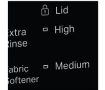
Lorsqu'il n'y a pas de témoin dans la colonne, le niveau d'eau sélectionné est « Auto » (automatique).
