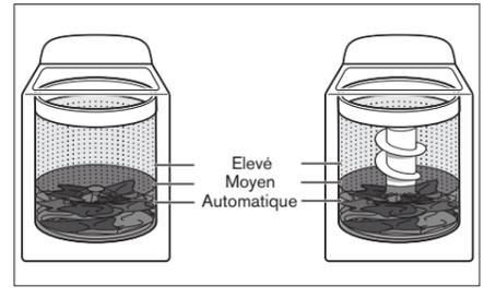
À mesure que la laveuse imbibe et déplace la charge, les articles se tassent dans le panier.
