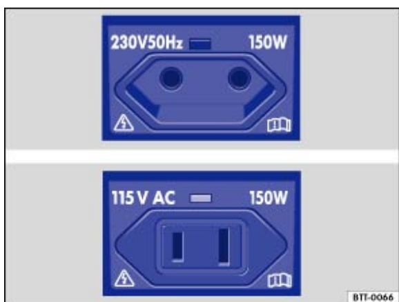
Fig. 132 230-volt Euro socket / 115-volt socket
