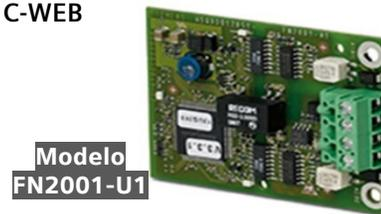
El módulo de red C-WEB (modelo FN2001-U1) se utiliza para establecer una conexión de red de hasta 32 FACP y el terminal de incendios (modelo FT924) a través del bus del sistema C-WEB. El módulo de red C-WEB se conecta a la unidad operativa estándar o la unidad operativa con LED. El módulo C-WEB admite la conexión en red "entre pares" en sistemas direccionables de 252/504 puntos, así como en un panel del terminal de incendios (modelo FT924).
