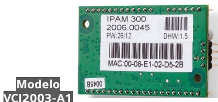
El módulo de Voz sobre protocolo de Internet (VOIP) (modelo VCI2003-A1) se utiliza para convertir señales de audio entre señales de voz sobre protocolo de Internet analógicas y digitales. Este módulo se instala en un punto de conexión en la tarjeta de CPU de voz (modelo VCA2001) y es necesario para todas las aplicaciones de voz de red.
