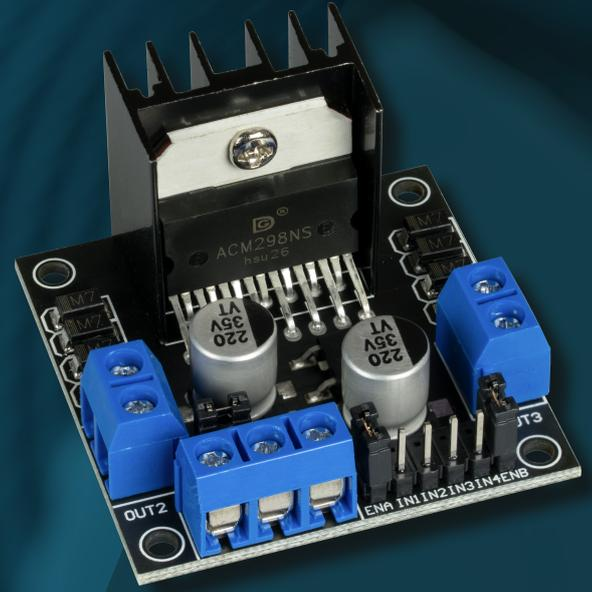
Der MotoDriver 2 ist eine leistungsfähige und vielseitige Erweiterungsplatine zur Steuerung und Stromversorgung von bis zu zwei Gleichstrommotoren. Ausgestattet mit dem bewährten L298N H-Brücken-Treiber ermöglicht das Modul die präzise Ansteuerung von Motoren in beide Drehrichtungen und eignet sich ideal für Anwendungen in den Bereichen Robotik, Automatisierungstechnik, Modellbau oder Bildung.
