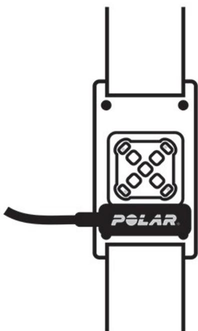
2. Durante o carregamento, os LEDs indicam o progresso: quatro LEDs vermelhos que giram no sentido horário mostram que o carregamento está em andamento e, quando a bateria está totalmente carregada, os LEDs vermelhos ficam acessos continuamente.
