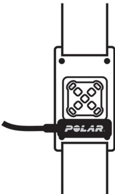
Durante o carregamento, os LEDs indicam o progresso: quatro LEDs vermelhos que giram no sentido horário mostram que o carregamento está em andamento e, quando a bateria está totalmente carregada, os LEDs vermelhos ficam acessos continuamente.
