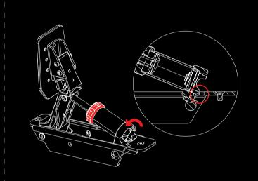
将撬棍翻转,放入弹簧桶底侧,向上用力将弹簧桶推入槽内
