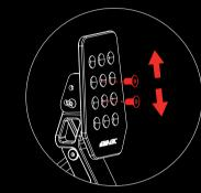
松开踏板正面的两颗螺钉 可对踏板的高度和左右位置 进行调节
