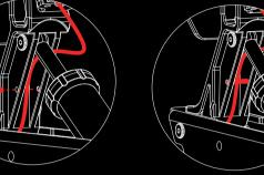
将P-HPR/P-HPR Neo 线材放入槽内
