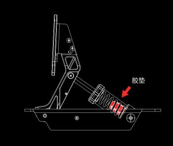
6.2 装上弹簧桶 拧回上盖,将弹簧桶放入卡位
