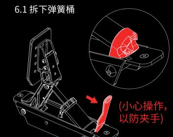
将撬棍放到弹簧桶底侧,向下用力,小心的将弹簧桶撬出
