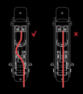
(注意: 刹车对应的黑色线材请留有余量, 防止线材过紧导致更换弹簧时扯断线材)
